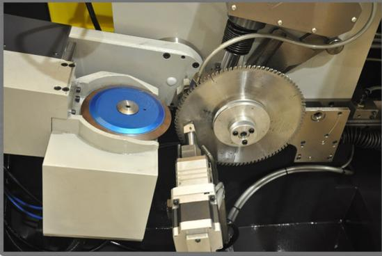
Akıllı tırnak ile otomatik kırık diş atlama ve şaşırtmalı diş adımlarını otomatik itme. Çift parçalı çizicileri tek seferde bilemek için Opsiyonel Pnömatik Sistem
