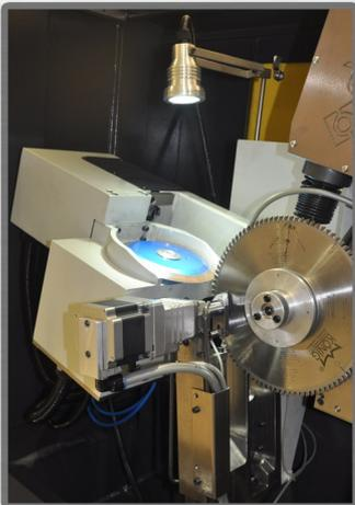
Patentli mikrostep sıkma ile otomatik et kalınlık, mesafe ve tork ayar imkanı
